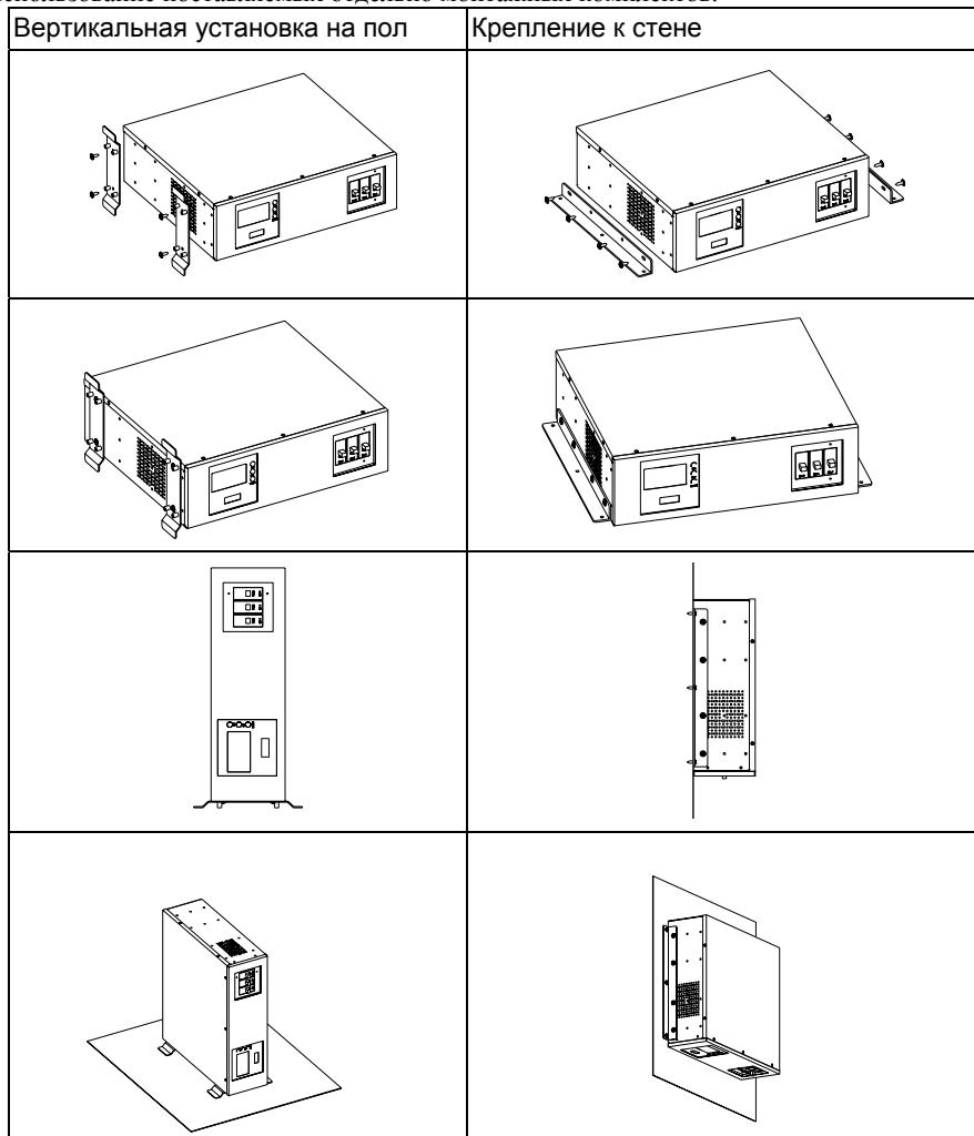
**2.9 Установка ИБП в стойку при помощи дополнительных монтажных комплектов:** Для установки ИБП в стойку возможно использование дополнительных монтажных комплектов (рельсы для установки в стойку в базовый комплект ИБП не входят).
